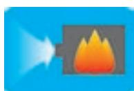
Termojolly è dotato di tubo d'aria comburente collegabile direttamente con l'esterno per garantire una corretta combustione della legna e non alterare i ricambi di ossigeno all'interno dell'ambiente.
