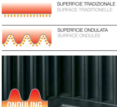
Da 40 anni Jolly-Mec progetta i propri focolari con un'esclusiva e brevettata ondulazione delle pareti interne del focolare (Sistema Onduling). Questo sistema fa sì che la superficie di scambio esposta al fuoco venga triplicata, aumentando il rendimento e ottenendo una combustione controllata e prolungata che nemmeno i moderni sistemi a doppia combustione possono eguagliare in prestazioni.
